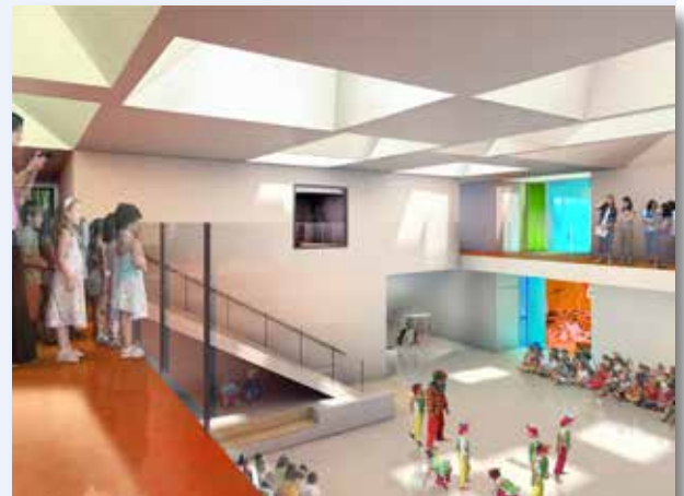
La lumière zénithale pénètre jusqu'au cœur du bâtiment via l'atrium central. Le recours à la lumière artificielle est, par conséquent, très faible.
